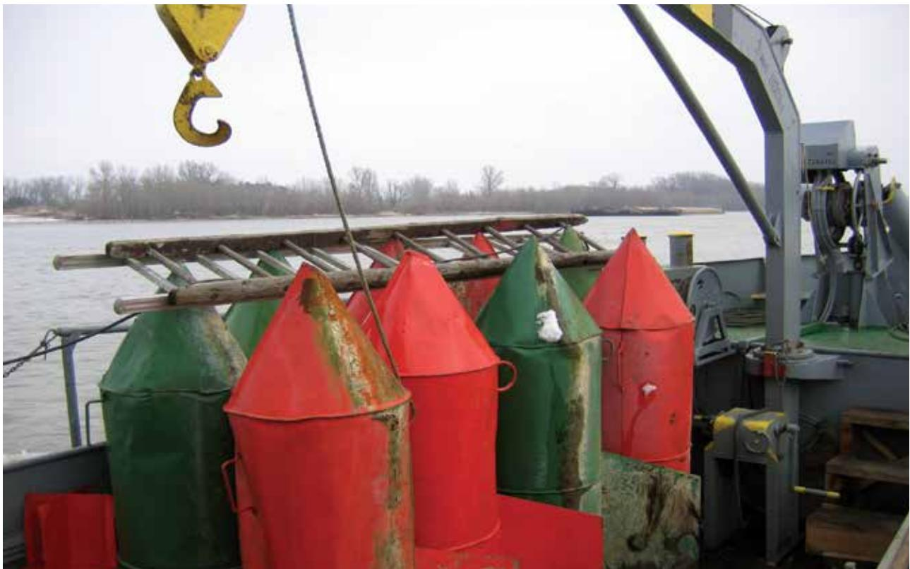
Zabezpečovanie plavebných podmienok - vytyčovanie plavebnej dráhy
