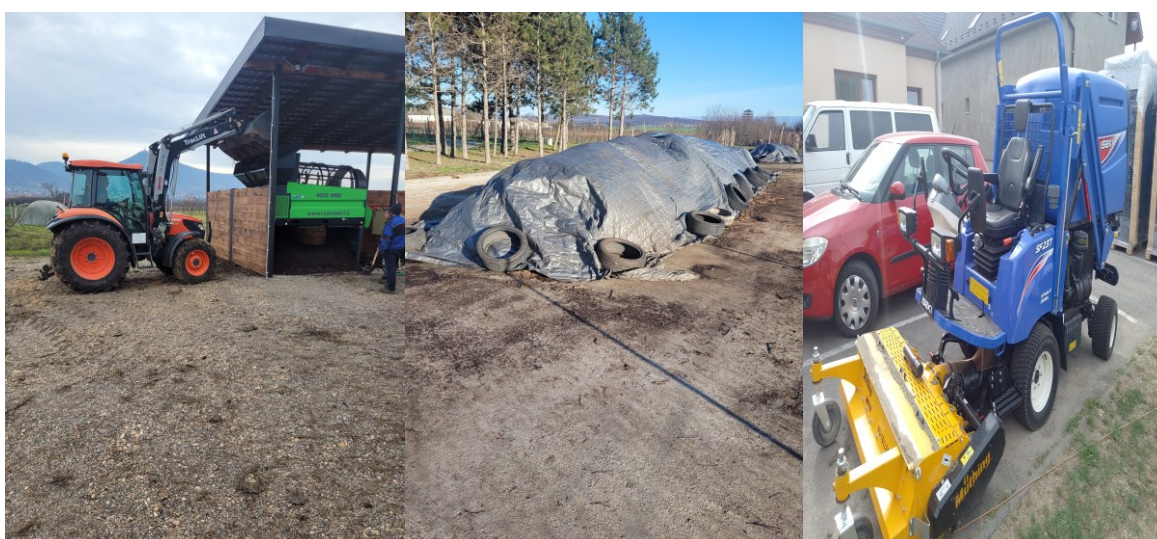
Novovytvárané kompostovište v obci s mulčovačom a rotačným triedičom
