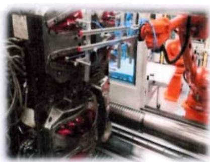
**Vstrekovanie plastov** je jedným zo základných spôsobov výroby plastových výrobkov a prvým krokom pri výrobe svetla. Vo všeobecnosti delíme technológiu vstrekovania na vstrekovanie viac komponentných výrobkov, akými sú napríklad svetelné kryty, či hrubostenné svetelné vodiče a vstrekovanie jedno komponentných výrobkov, najmä puzdier, reflektorov, clón a niektorých druhov tenkostenných svetelných vodičov.
