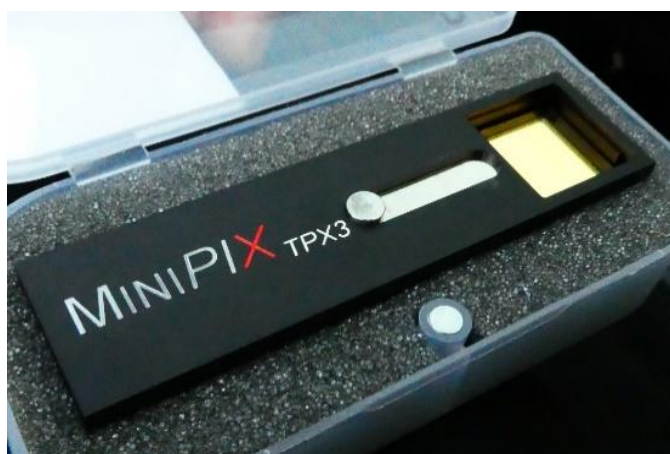
Vľavo: prototyp Timepix3 radiačnej kamery s SiC senzorom
