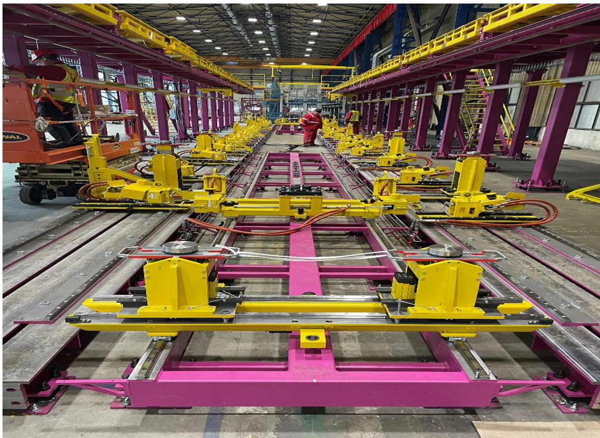
HYDRAULICKÉ ZARIADENIE NA ZVÁRANIE VAGÓNOV pre SLAVIA PRODUCTION SYSTEMS a.s.
