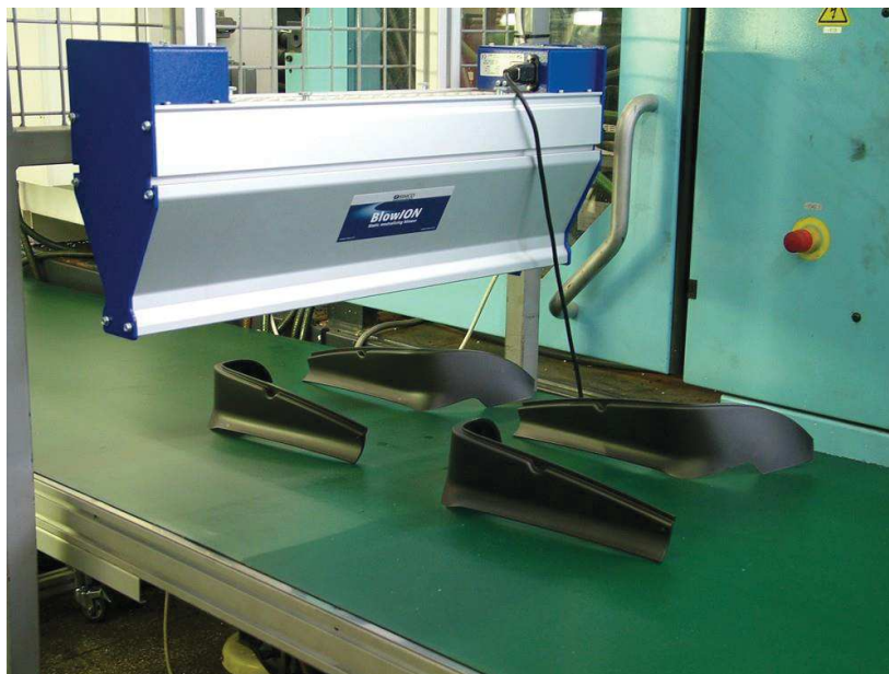
Ionizačná jednotka, ktorá odstráni znečistenie a prašnosť plastových dielcov
