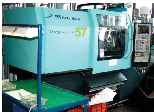
Plnoautomatické pracovisko so vstrekolisom Demag
