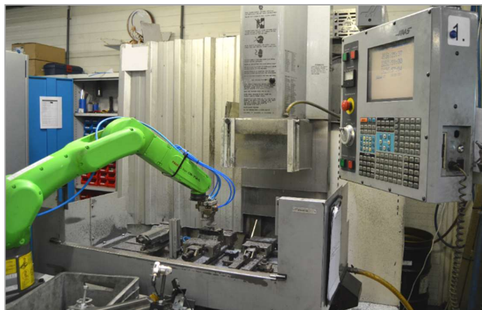
CNC fréza s kolaboratívnym robotizovaným pracoviskom v spoločnosti Global Industrial Parts, s.r.o.
