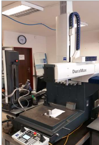
3D TOUCH PROBE, CMM, Zeiss, využívaný na kontrolu výrobkov
