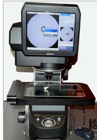
2D LIGHT TOUCH PROBE, Keyence, používaný na kontrolu výrobkov
