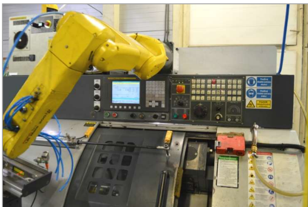
Robotizované pracoviská sú rovnako súčasťou sústruhov
