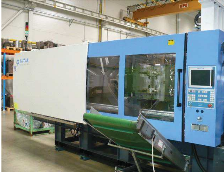
Jedna z investícií v posledných rokoch - vstrekovací lis HAITIAN s prísl., HT 5300/840 - 5000
