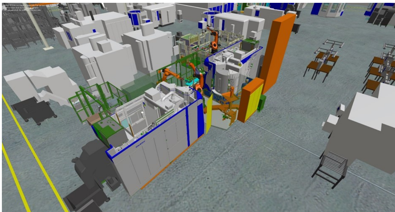
3D model robotického ostrova pre výrobu Controls (virtuálny pohľad)
