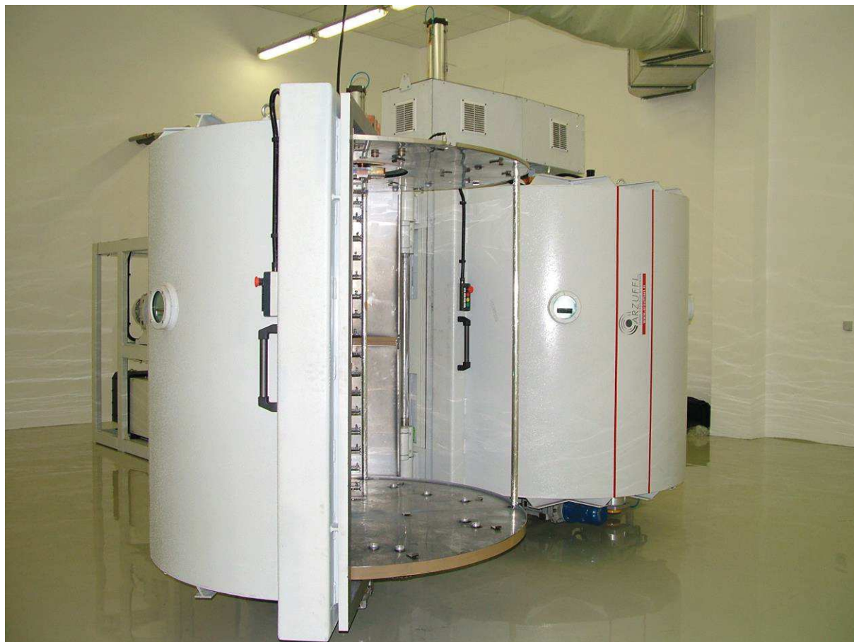
Linka pre technológiu vákuového naparovania hliníka
