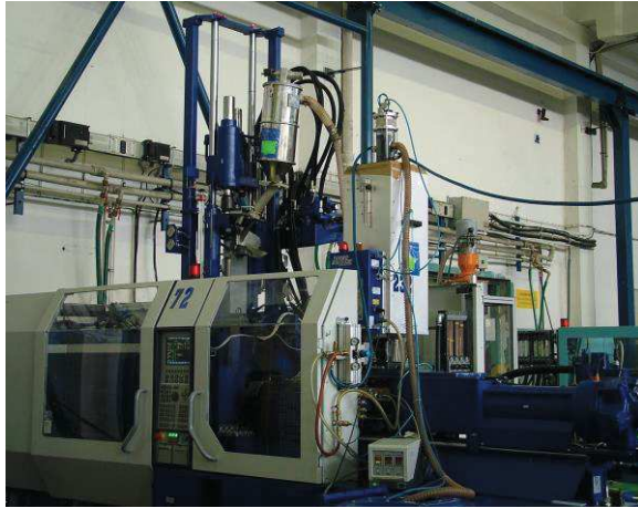
Vstrekovací lis DEMAG 150/500/610h/310/V - dvojkomponentný (dve vstrekovacie jednotky)
