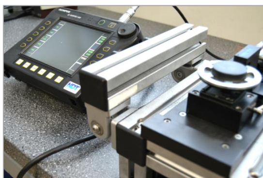
Vírivé prúdy používané na kontrolu komplikovaných výrobkov
