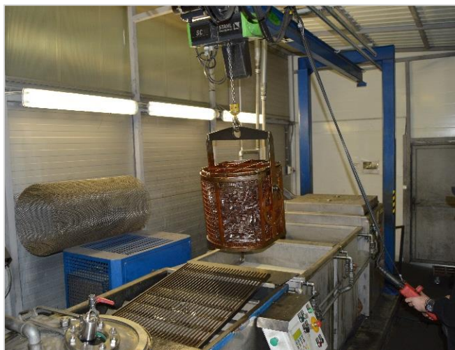
Impregnácia pórovitých dielov živicom, tzv. Maldaner vo firme ELTE, s.r.o.
