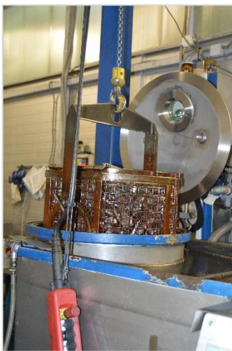
Impregnácia pórovitých dielov živicom, tzv. Maldaner vo firme ELTE, s.r.o.
