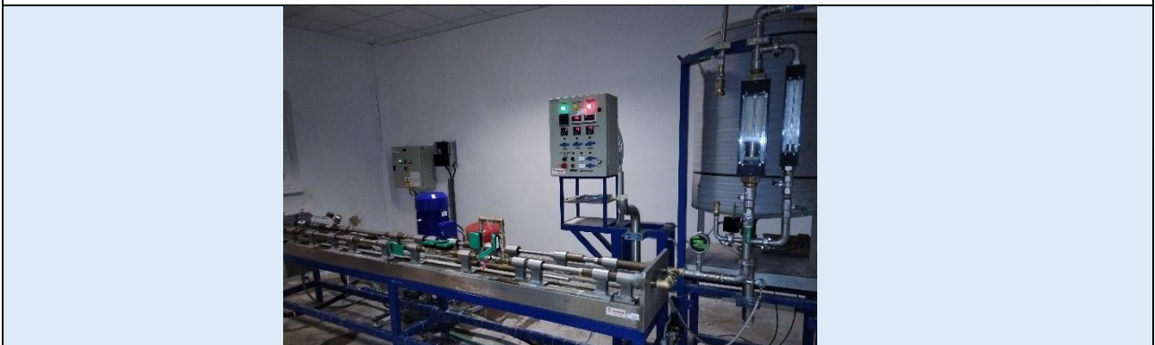
Obrázok č.9 Skúšobná trať na skúšanie vodomero
