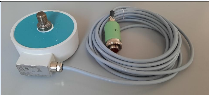
Obrázok č.4 Tenzometrický snímač sily ťahovej a tlakovej sily 1-Z4A/20KN
