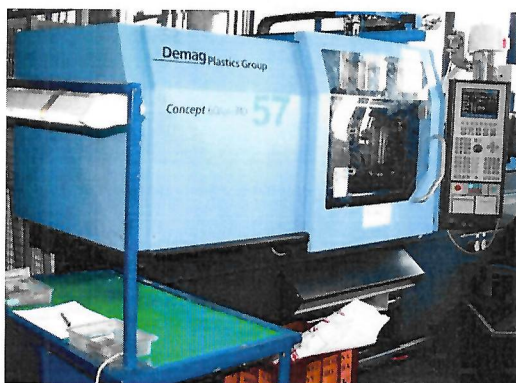
Plnoautomatické pracovisko so vstrekolisom Demag
