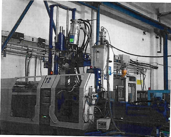
Vstrekovací lis DEMAG 150/500/610h/310/V - dvojkomponentný (dve vstrekovacie jednotky)
