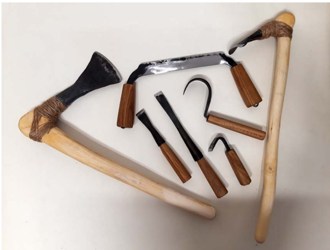
Experimentálne vyrobené nástroje, ktoré slúžili na výrobu monoxylu z doby železnej
