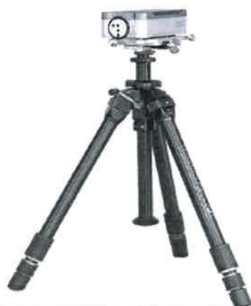
Obrázok č. 10 Nový interferometer a kalibrátor rozačných osí XR20 od RENISHAW
