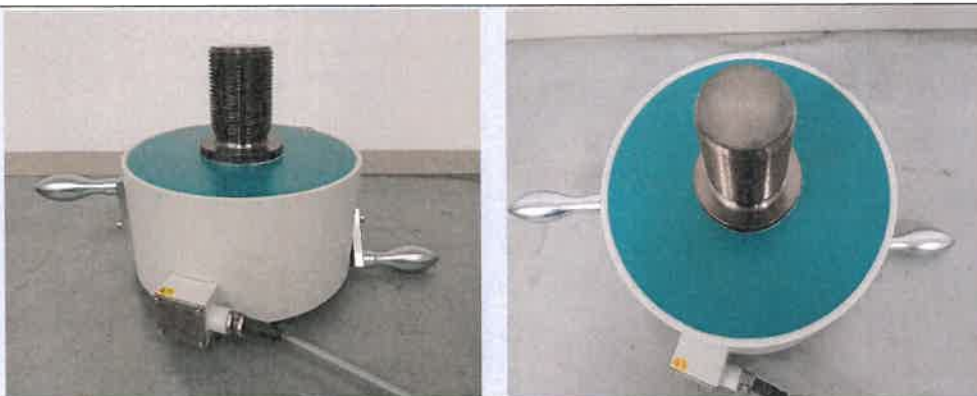
Obrázok č. 8 Tenzometrický snímač Z4A 500 kN
