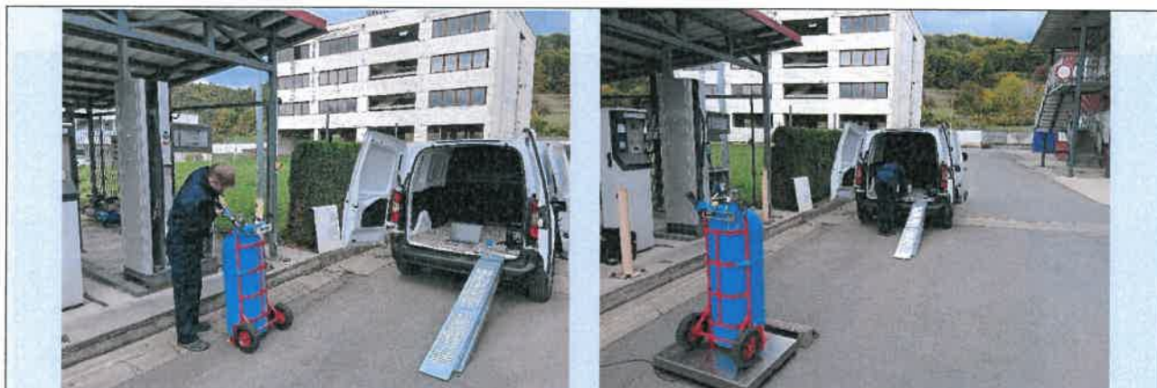
Obrázok č. 11 Nová tlaková nádoba na kontrolu výdajných stojanov CNG
