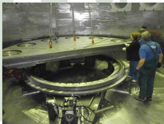
Obr. č. 14 a 15 / Inštalácia komponentov zvracieho polohovadla 100t
