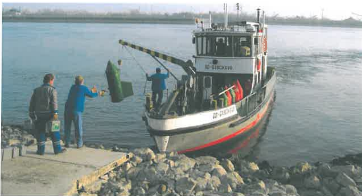
Zabezpečovanie plavebných podmienok - vytyčovanie plavebnej dráhy
