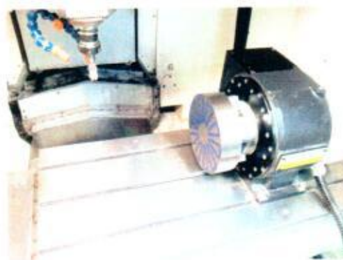
Obrázok 6 Aplikácia elektromagnetického upínača
