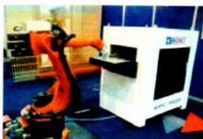
Obrázok 8 Robotické pracovisko so zásobníkom obrabkov RPC
