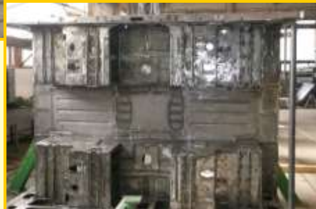
Súpravy nízko podlažných električkových súprav platformy AVENIO určených pre dopravného operátora v Mníchove (D) (vľavo) resp. dopravného operátora R-NET v Den Haag (NL) a zváraná podskupina karosérie vozňa UG Mittelteil .
