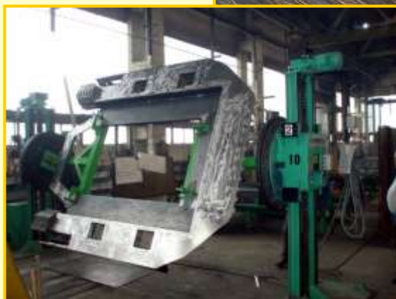
Jedna zo štyroch typov čelných stien pre vozne súprav ČD Railjet v procese výroby
