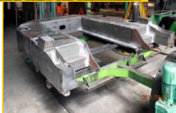
Jedna z dvoch typov čelných stien pre lôžkový vozeň WLABmz RŽD v procese výroby
