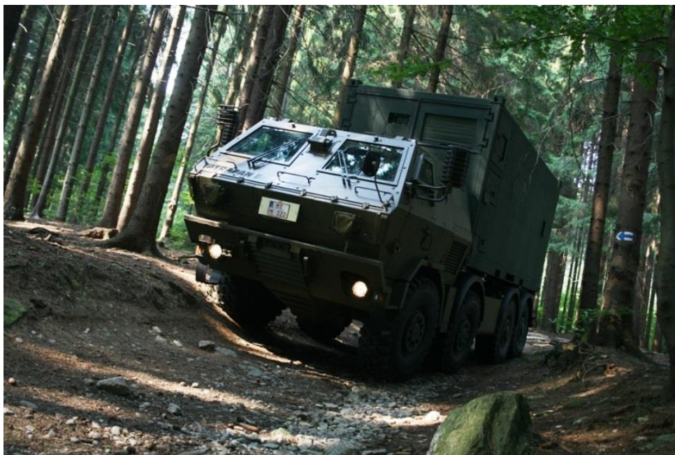
Obr. č. 10 / Nosič kontajnerov TATRAPAN 8x8 CC s kontajnerom z projektu C2 Shelters
