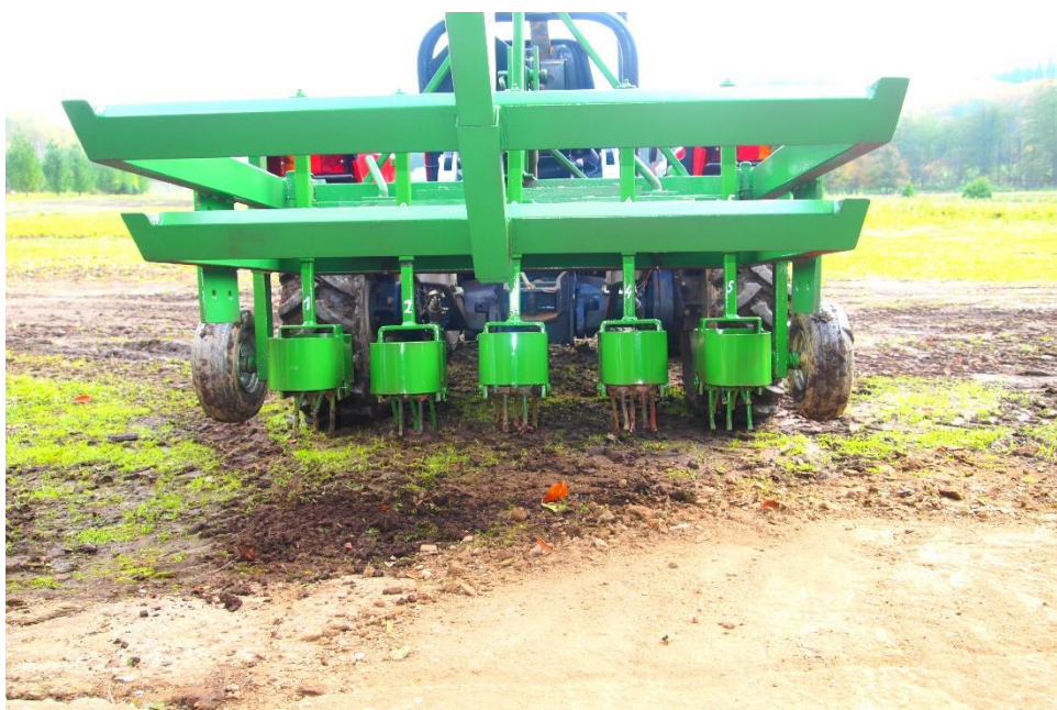
Svojpomocne vyrobený viacúčelový vozík pre účely malotraktora s kypriacimi hlavicami
