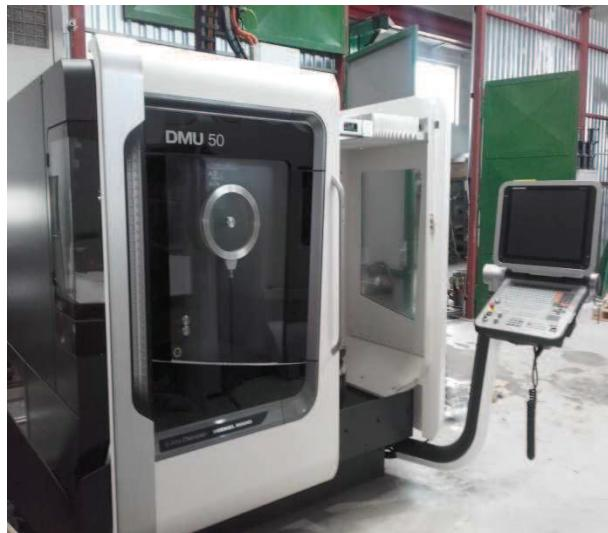
*Obrábacie stroje boli rozšírené o moderné 5 - osé obrábacie centrum DMU 50 Deckel Maho, dodávané renomovanou nemeckou spoločnosťou DMG MORI. Táto modernizácia umožňuje vyrábať pre našich odberateľov aj najzložitejšie výrobky.*
