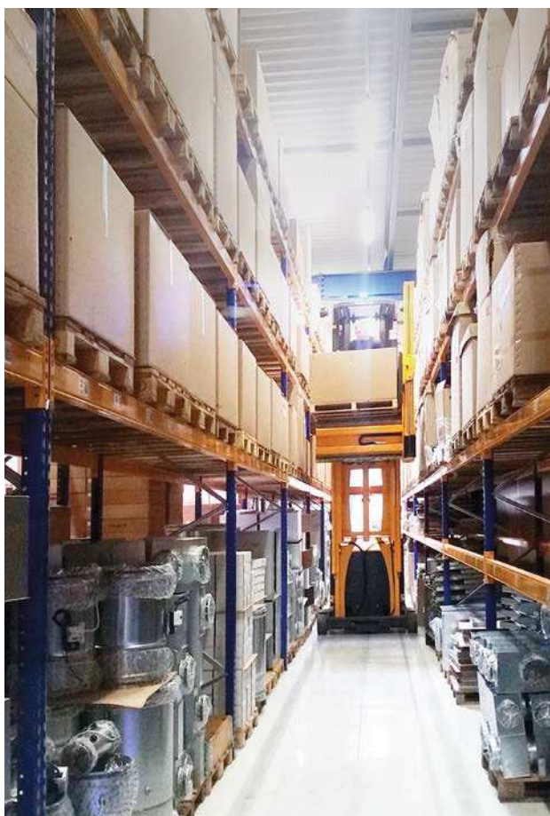
Nová manipulačná – skladovacia technika -indukčne navádzaný vozík
