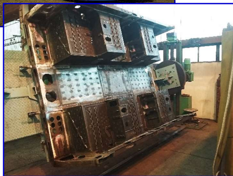
Súprava č.2808 nízko podlažnej elektríkovej súpravy platformy AVENIO na linke č.21 v Mníchove (D) (foto Frederik Buchleitner) a zváraná podskupina spodného rámu karosérie vozňa UG Mittelteil pre projekt platformy AVENIO v rovnacom prípravku.
