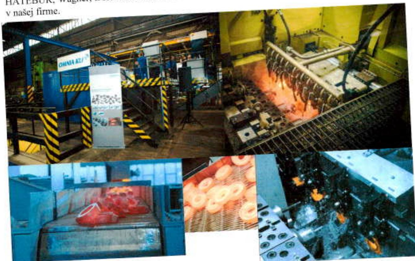
Vstupným materiálom je tyčová oceľ – predovšetkým vysokoakostná ložisková oceľ, materiál 14 109 (100Cr6) a 14 209 (100CrMn6) - ocele k chemicko-tepelnému spracovaniu a k zušľachtovaniu, vhodné na tvárnenie za tepla, na výrobu výkovkov predovšetkým pre automobilový priemysel.
