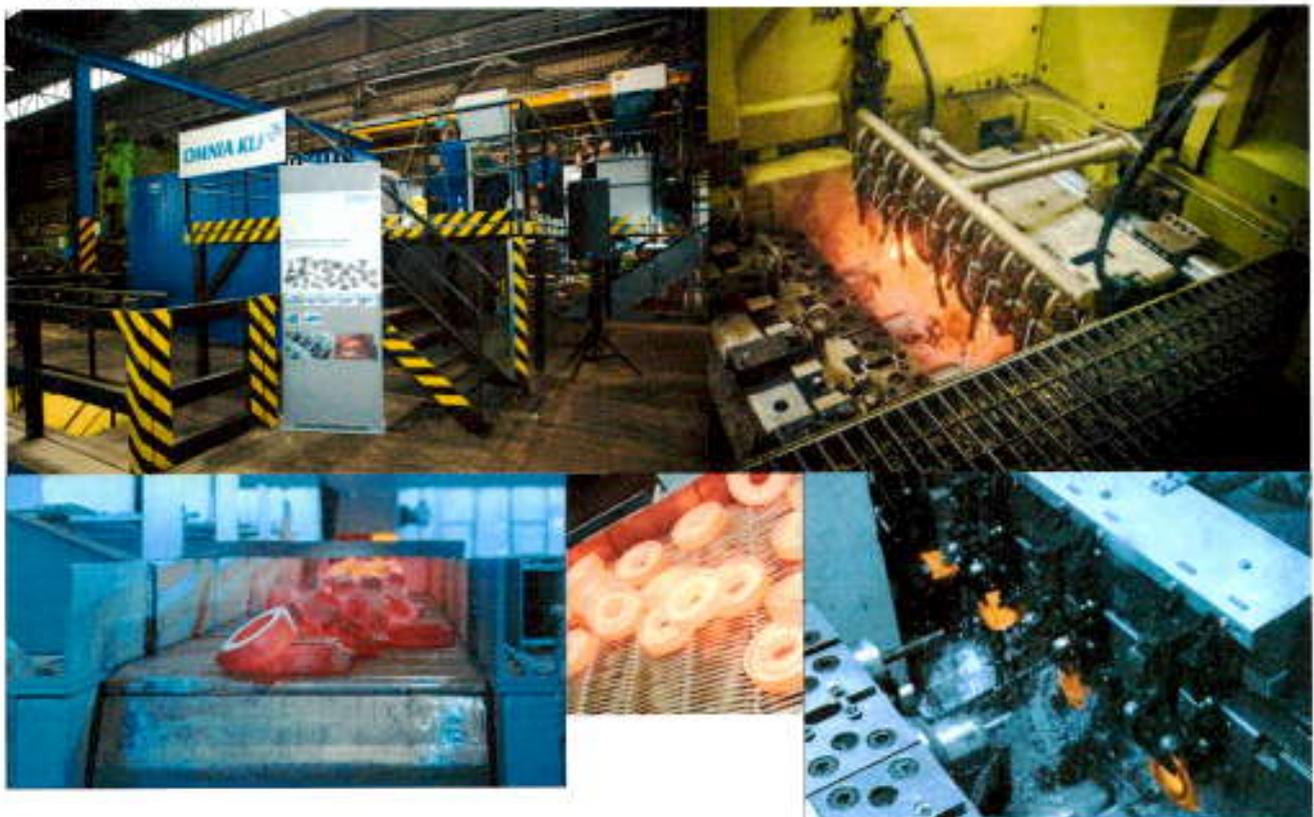
Vstupným materiálom je tyčová oceľ – predovšetkým vysokoakostná ložisková oceľ, materiál 14 109 (100Cr6) a 14 209 (100CrMn6) - ocele k chemicko-tepelnému spracovaniu a k zušľachťovaniu, vhodné na tvárnenie za tepla, na výrobu výkovkov predovšetkým pre automobilový priemysel.
