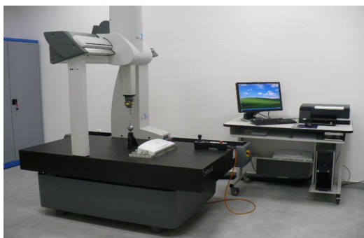
Špičkové pracovisko oddelenia kvality s 3 D meracím prístrojom
