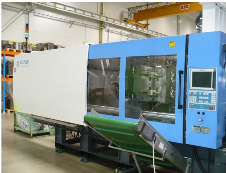
Jedna z najnovších investícií - vstrekovací lis HAITIAN s prísl., HT 5300/840 - 5000
