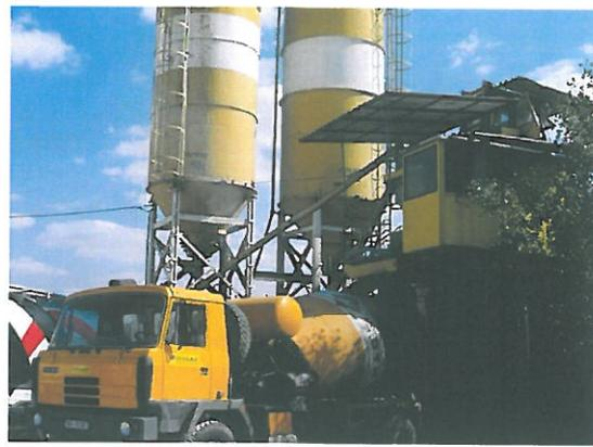
V roku 2005 prebehla na betonárke rozsiahla modernizácia, vďaka čomu dosahujeme výkon 30 m<sup>3</sup>/hod. Dopravu betónových zmesí zabezpečujeme vlastnými autodomiešavačmi s kapacitou 5 a 6 m<sup>3</sup>. Samozrejmosťou je zabezpečenie vykládky vlastným čerpadlom na betón - PUTZMEISTER s dosahom 27 m<sup>3</sup>.
