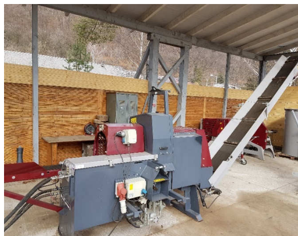
Linka na výrobu štiepaných ihličnatých triesok
