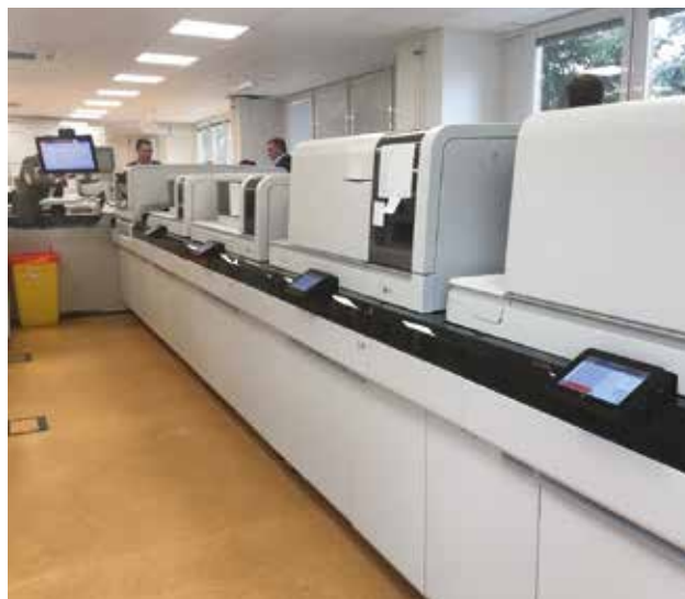
Analyzátory Atellica Solution pripojené do automatizovanej linky Aptio v laboratóriu Alpha medical Stropkov.
