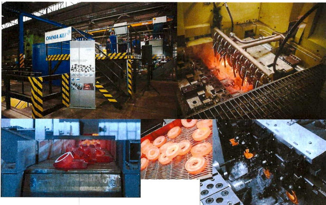
Vstupným materiálom je tyčová ocel – predovšetkým vysokoakostná ložisková ocel, materiál 14 109 (100Cr6) a 14 209 (100CrMnSi6-4), taktiež ocele cementačné, ocele k zušľachtovaniu, vhodné na tvárenie za tepla, na výrobu výkovkov predovšetkým pre automobilový priemysel a ložiskový priemysel.
