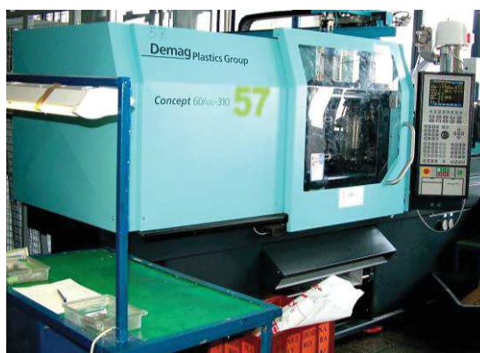
Plnoautomatické pracovisko so vstrekolisom Demag
