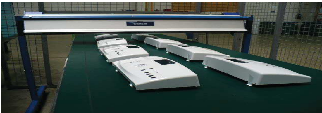
Ionizačná jednotka, ktorá odstráni znečistenie a prašnosť plastových dielcov
