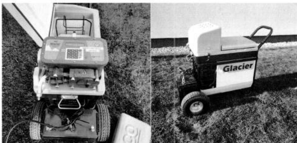
Na odber vzoriek z ČOV bol zakúpený nový prenosný automatický vzorkovač s chladením GLACIER
