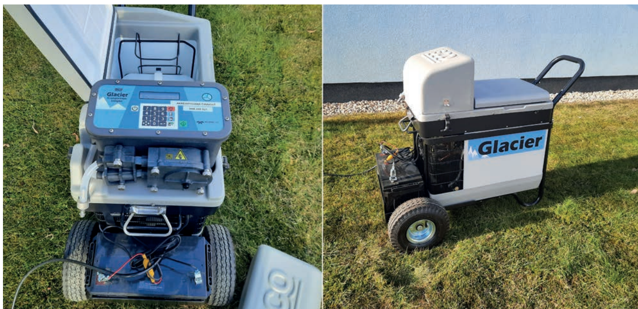
Na odber vzoriek z ČOV bol zakúpený nový prenosný automatický vzorkovač s chladením GLACIER
