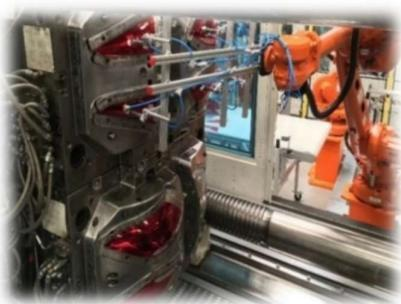
**Vstrekovanie plastov** je jedným zo základných spôsobov výroby plastových výrobkov a prvým krokom pri výrobe svetla. Vo všeobecnosti delíme technológiu vstrekovania na vstrekovanie viac komponentných výrobkov, akými sú napríklad svetelné kryty, či hrubostenné svetelné vodiče a vstrekovanie jedno komponentných výrobkov, najmä puzdier, reflektorov, clón a niektorých druhov tenkostenných svetelných vodičov.
