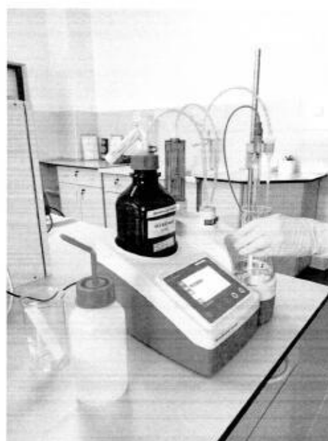
Nové vybavenie v laboratóriu analýzy pitných a odpadových vôd. Čítačka kolónií pri mikrobiologických stanoveniach a automatická titračná jednotka.
